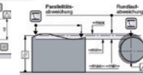
Programmfunktion für Form- und Lageabweichungen - Messen in Verbindung mit dem TESA Messtaster IG 13
