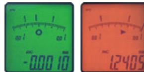
Das Display schaltet bei Über- bzw. Unterschreitung der Toleranzgrenzen automatisch von grün auf rote Hintergrundbeleuchtung
