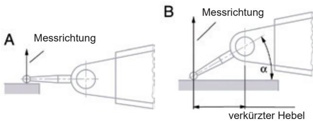
**Anwendungshinweise für Fühlhebelmessgeräte P-Line**
